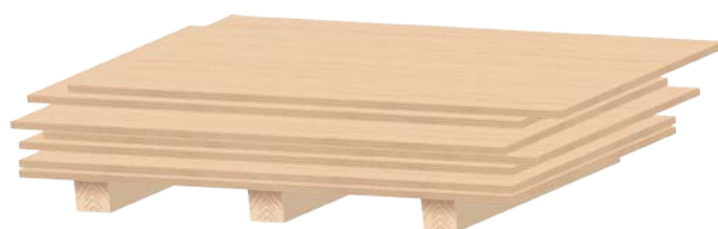
Fig. 4 - De platen zijn niet juist gestapeld. Hierdoor kunnen ze verkleuren en vervuild raken. Ook kunnen de randen makkelijk beschadigd worden.
