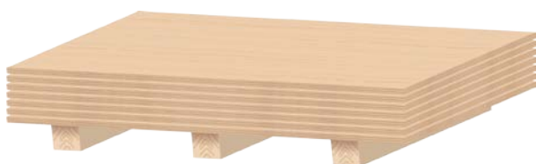
Fig. 3 - De platen liggen correct recht boven elkaar.
