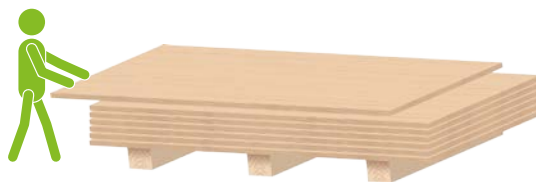
Fig. 6 - Zorg ervoor bij het oppakken van een plaat dat deze niet met 1 hoek over de onderliggende plaat wordt getrokken. Dat veroorzaakt namelijk krassen in het dekfineer.
